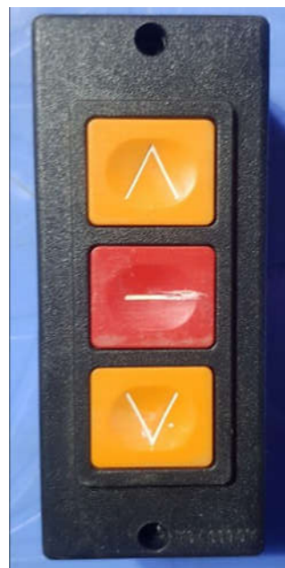
công tắc thường có tiếp điểm stop là thường đóng
